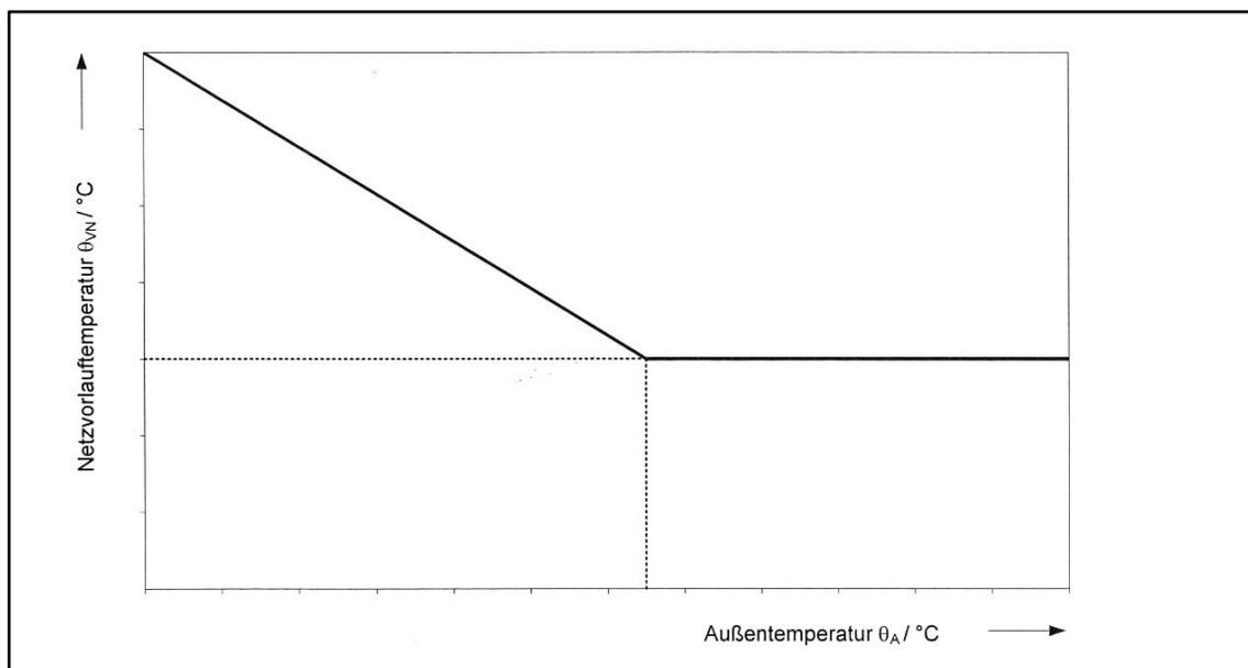
Abbildung 1: Netzvorlauftemperatur  $\Theta_{VN}$  in Abhängigkeit von der Außentemperatur  $\Theta_A$ ; prinzipieller Verlauf einer gleitend-konstanten Fahrweise
