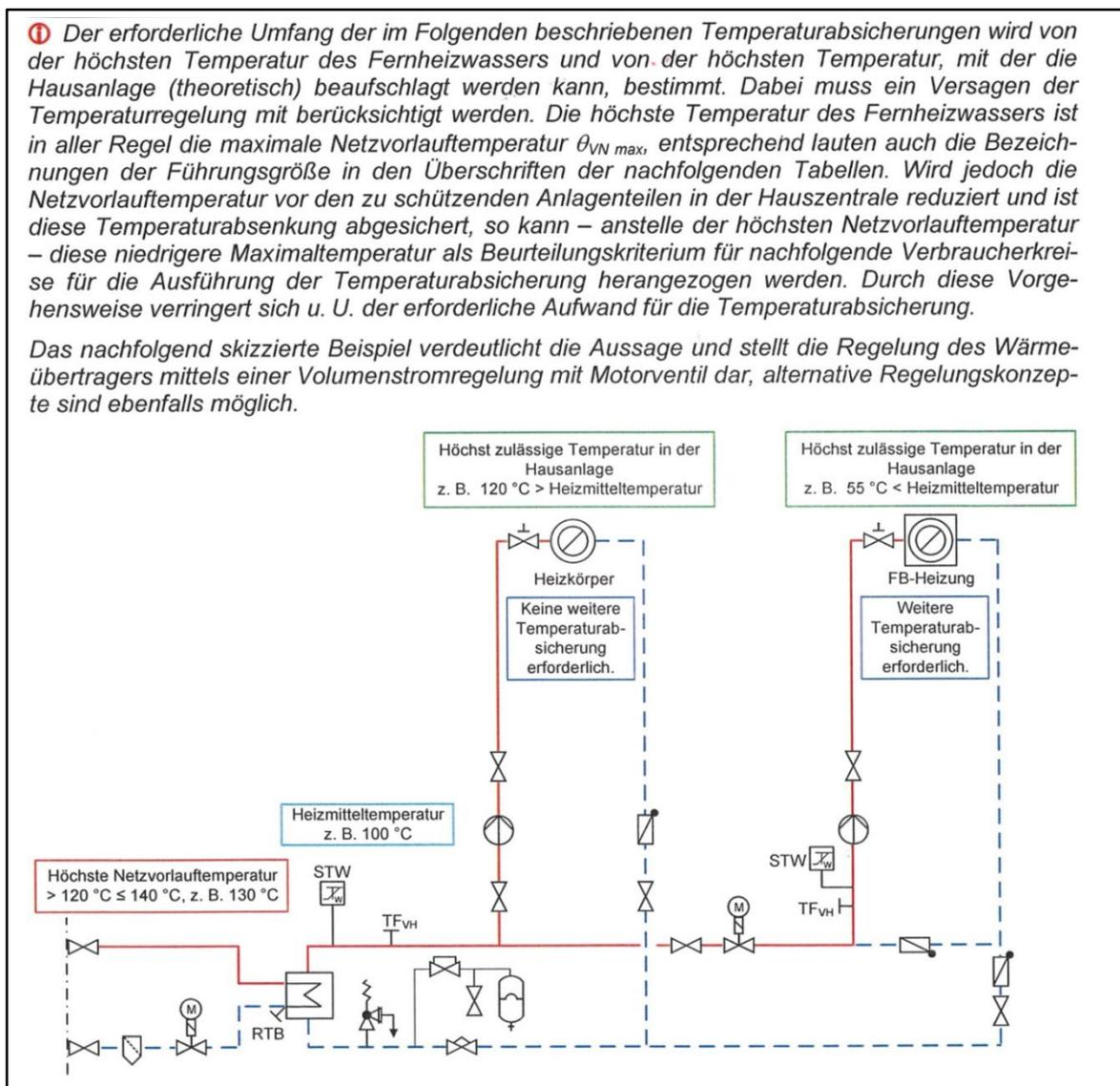
Beispiel für die Reduzierung der erforderlichen sicherheitstechnischen Ausrüstung durch Absenkung der Netzvorlauftemperatur
