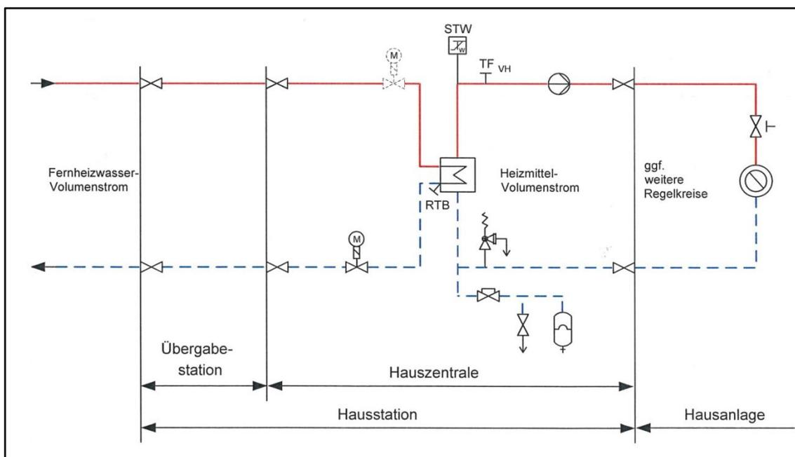
Abbildung 7: Hauszentrale-Raumheizung, Prinzipschaltbild für den indirekten Anschluss
