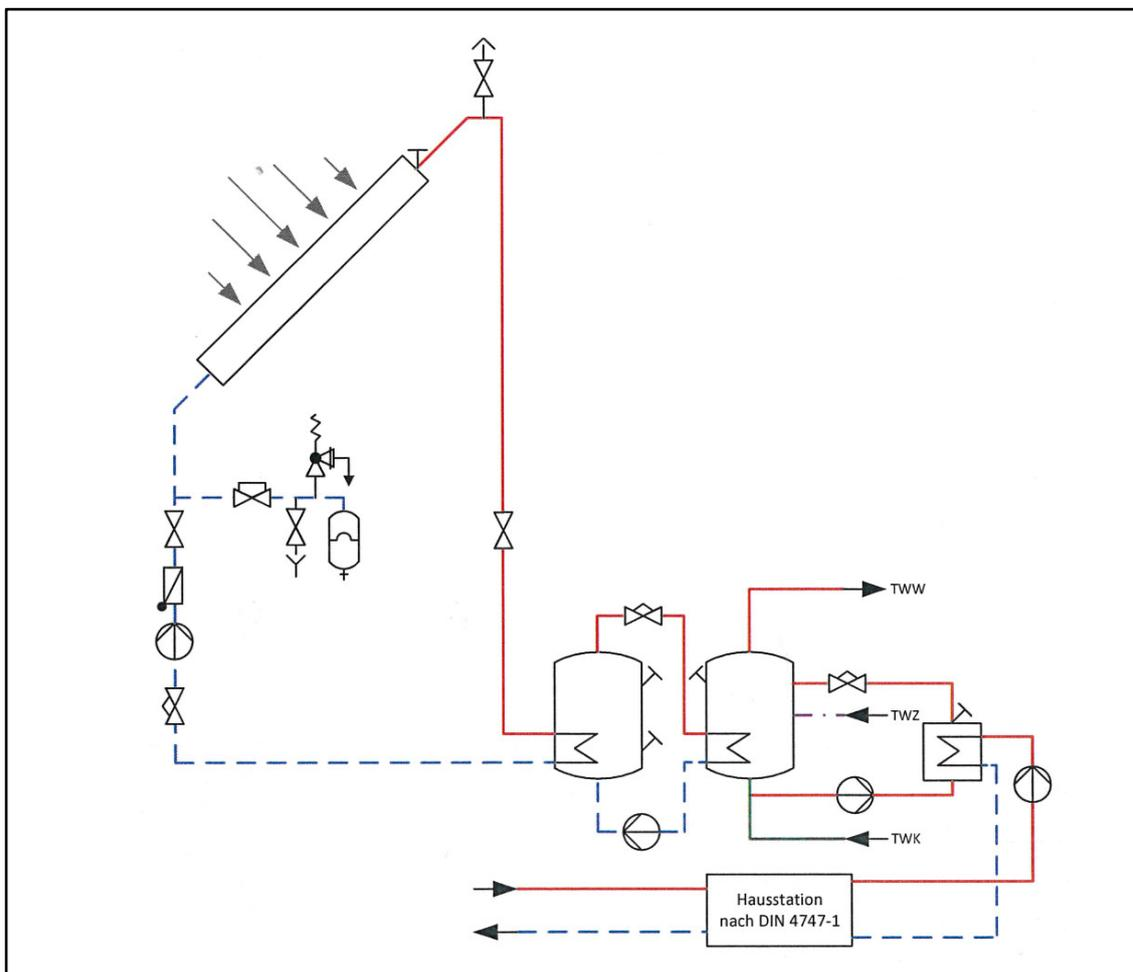
Abbildung 12: Solaranlage mit Pufferspeicher und Trinkwassererwärmer mit außen liegendem Wärmeübertrager für die Nachheizung
