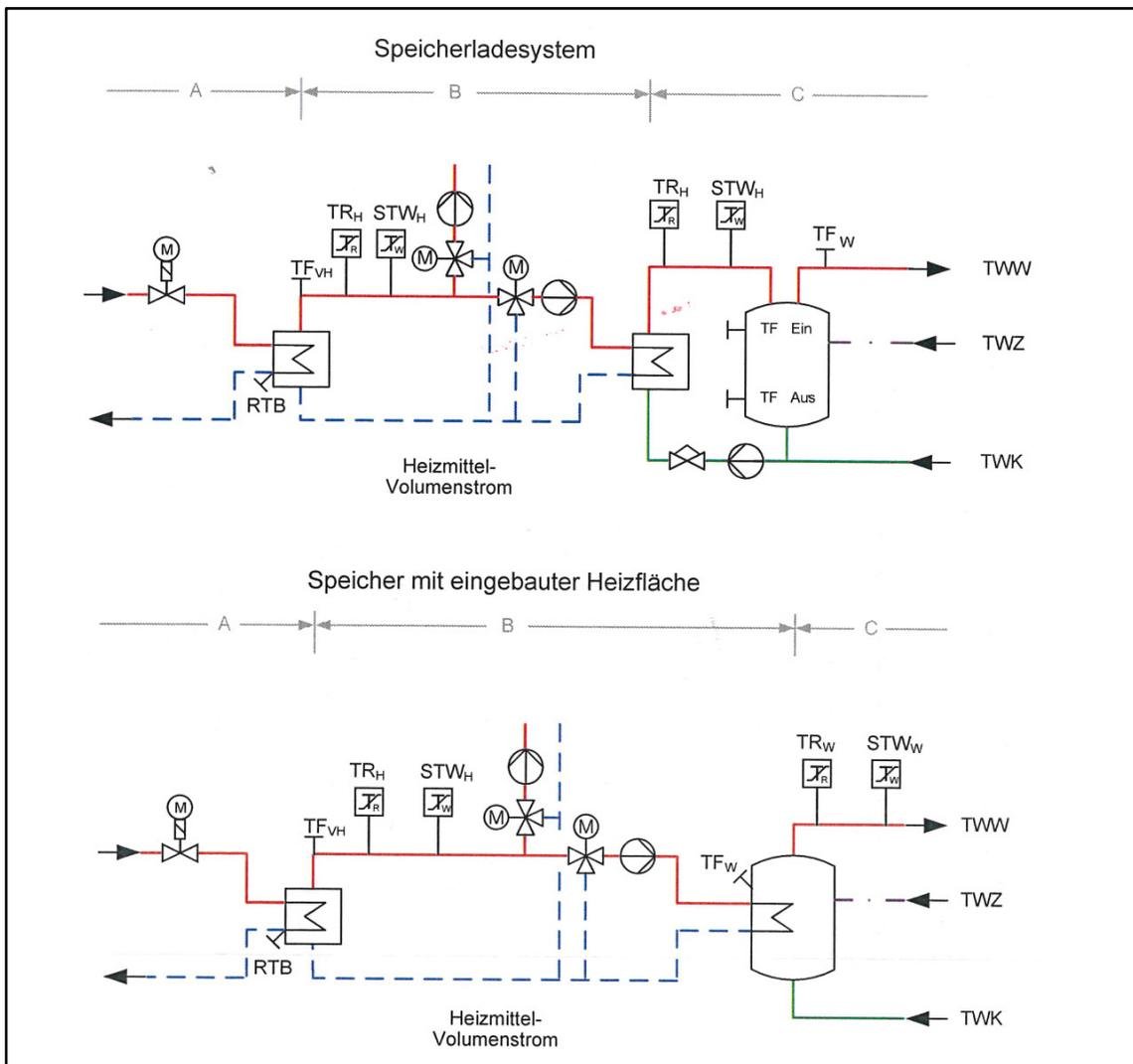
Abbildung 9: Hauszentrale Trinkwassererwärmung
