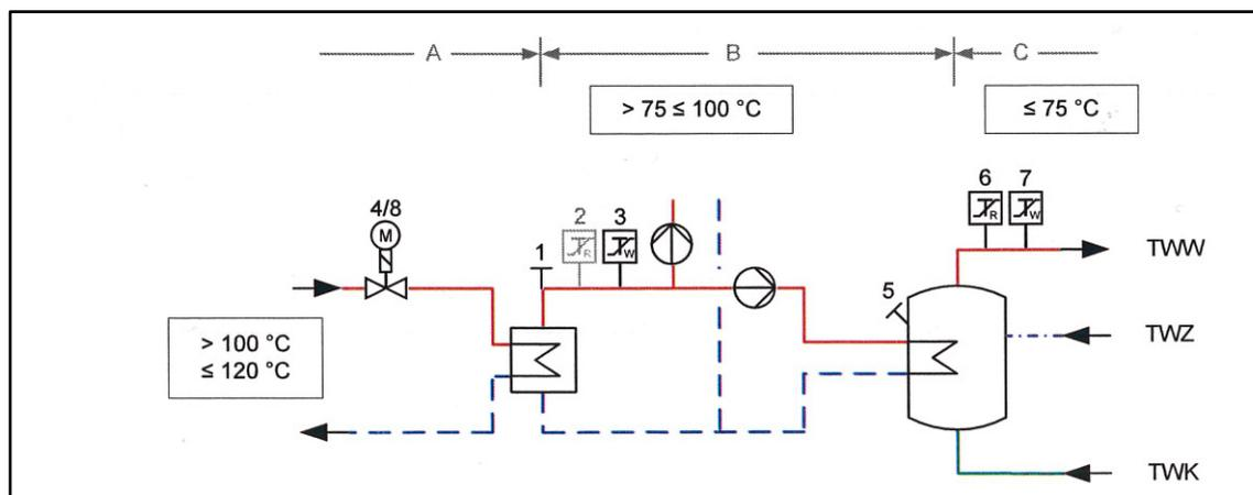
Abbildung zur Tabelle 7: Erforderliche sicherheitstechnische Ausrüstung nach Zeile 2; grau dargestellte Komponenten nicht erforderlich
